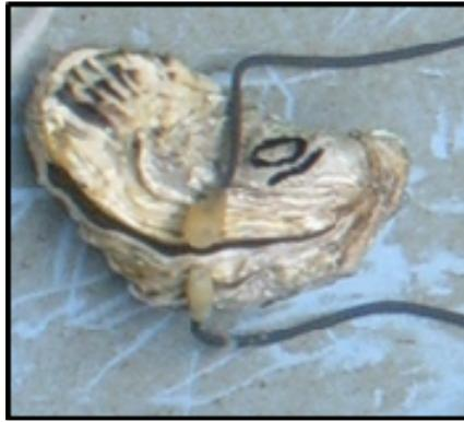
Figure 2 : Huître équipée de deux électrodes légères.
